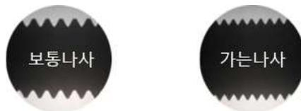
Major Diameter는 나사의 산에 접하는 가상 원통의 지름이며, Minor Diameter은 나사의 골에 접하는 가상 원통의 지름을 지칭한다. 물론 너트와 같은 Internal Thread에서는 나사의 골에 접하는 가상 원통의 지름이 Major Diameter가 된다. 통상 Major Diameter를 나사의 공칭경(Nominal Diameter)이라 한다.
